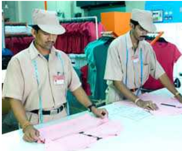
Gambar 9.9 Toleransi ukuran/allowance Pemeriksaan ukuran kemeja, meliputi item dan toleransi berikut :
