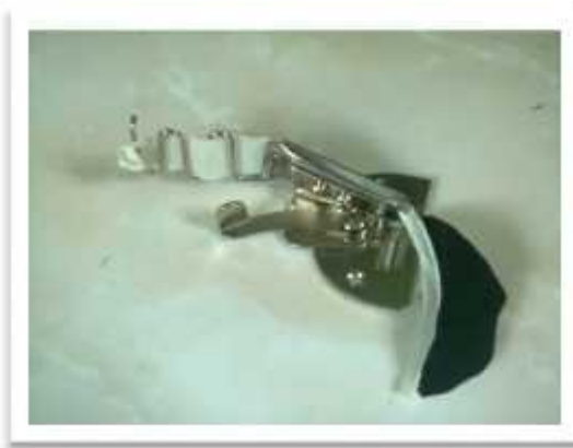
Gambar 7.23 Corong bisban mesin jahit manual
